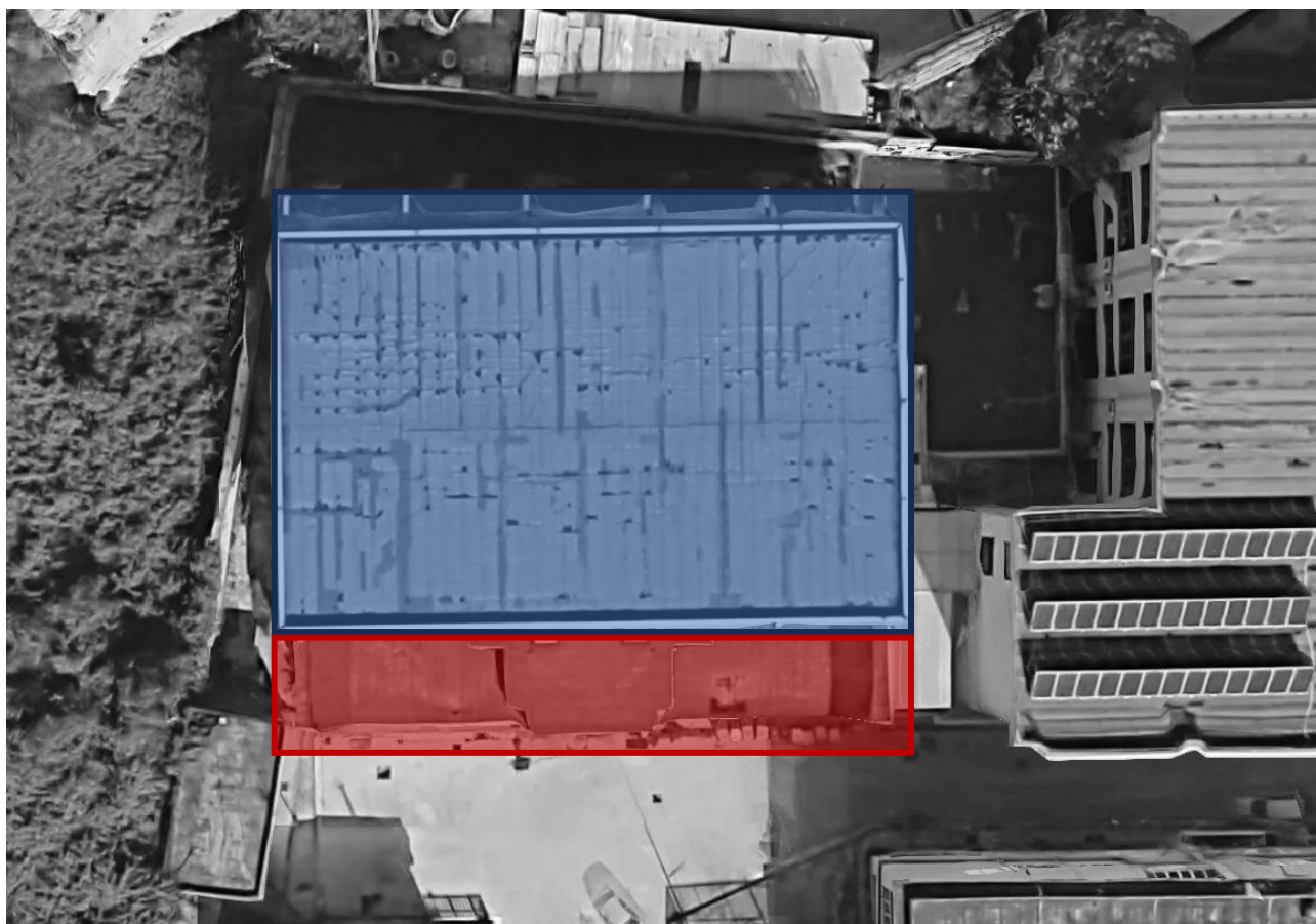
Schema di suddivisione dei blocchi strutturali: in blu la palestra e in rosso il blocco spogliatoi
