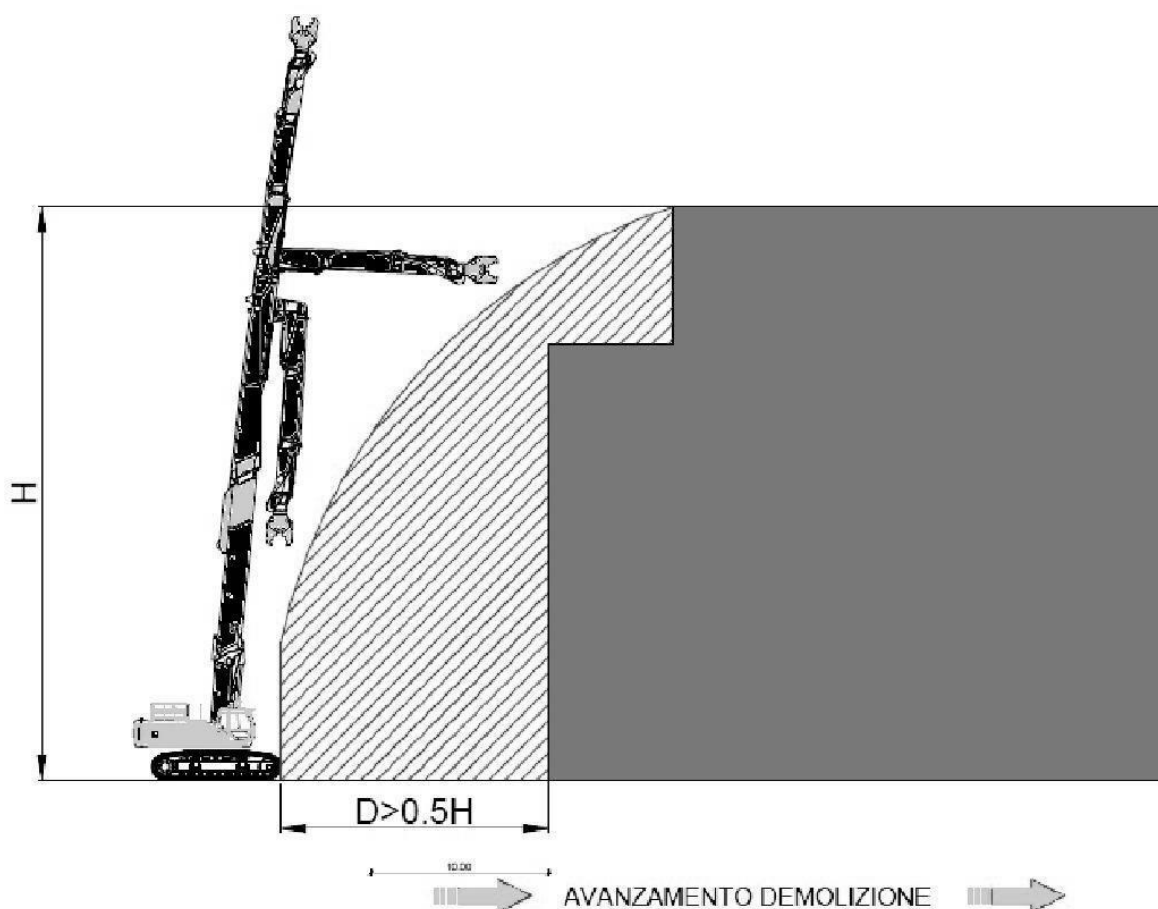
Schema generale di demolizione
