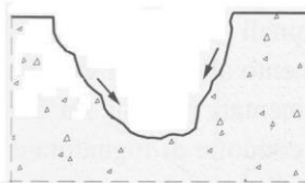
Figura 3 - Possibili smottamenti nello scavo delle trincee
