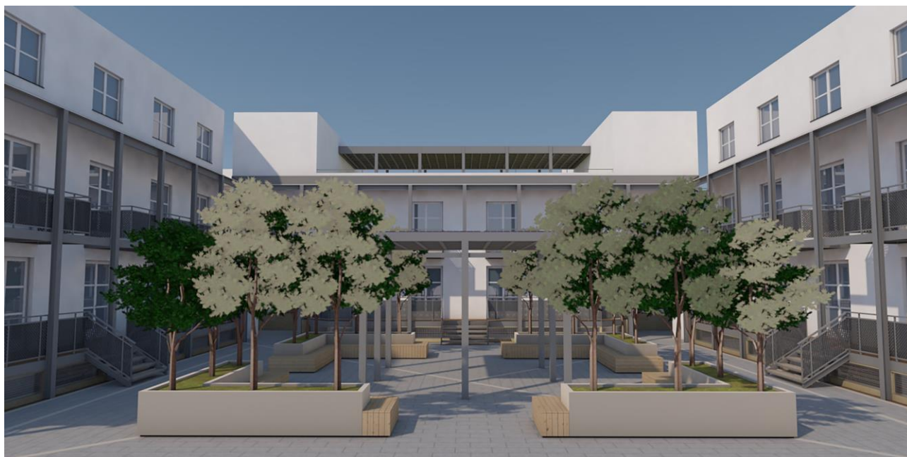
Vista della corte grande con gli interventi qualificanti per la riduzione degli impatti ambientali, l'adattamento climatico, la riduzione dei fabbisogni energetici; inserimento del pergolato FV, di sedute e alberature e, in copertura, della pensilina FV.
